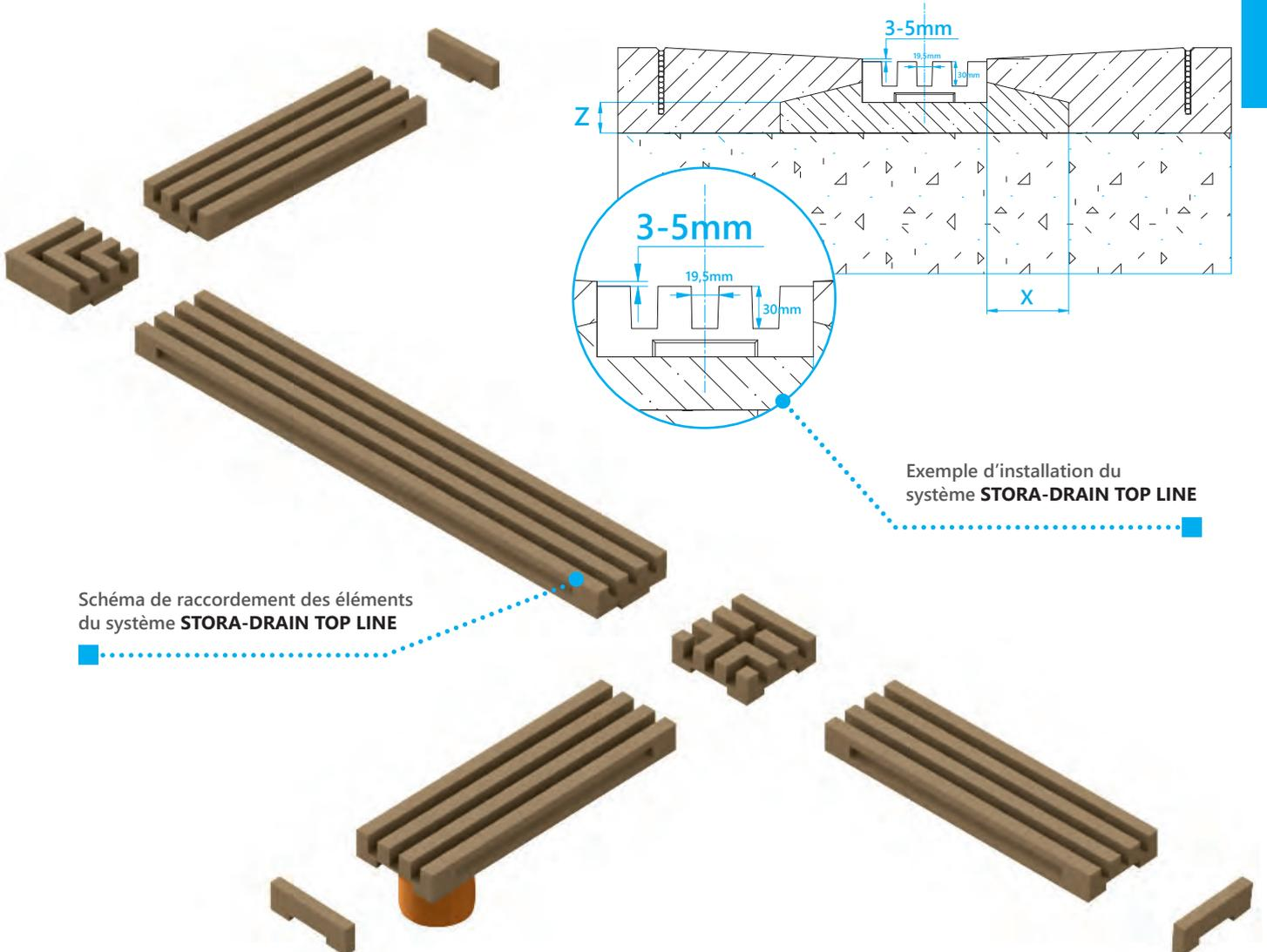
Schéma de raccordement des éléments du système **STORA-DRAIN TOP LINE**
